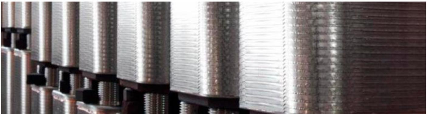
Принципиальное отличие паяного теплообменника от разборного заключается в том, что в паяном ТО пакет пластин из нержавеющей стали уплотняется не с помощью прокладок, а путем спайки пластин с использованием медного припоя. Такая конструктивная особенность обуславливает основные плюсы и минусы паяного теплообменника.
